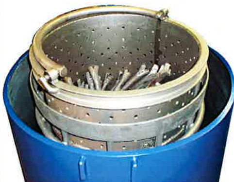
Vue du panier amovible dans son porte panier Centrifuge removable basket inside the carrier
