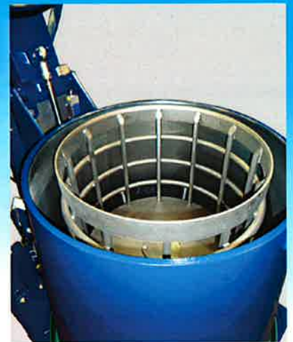
Vue du porte panier Centrifuge basket carrier
